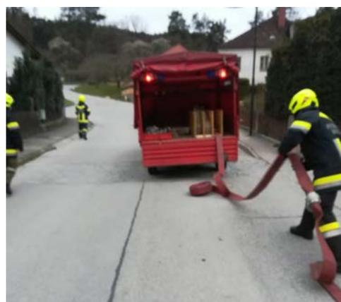
fertig gekuppelte Schläuche in speziellen Boxen erleichtern den Aufbau langer Löschleitungen
