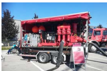
Großpumpenanlage, Pumpleistung 900m 3 /min
